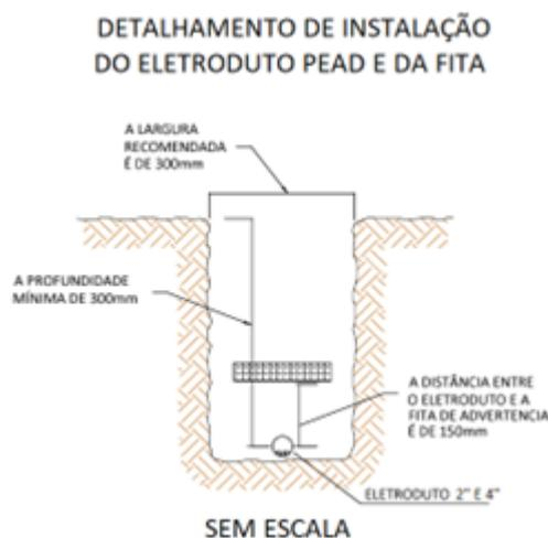
3.22.2. Em linhas subterrâneas, os condutores não poderão ser enterrados diretamente no solo, devendo, obrigatoriamente, serem instalados em dutos corrugados em polietileno de alta densidade (PEAD) para assegurar proteção mecânica aos condutores e permitir sua fácil substituição em qualquer tempo.
