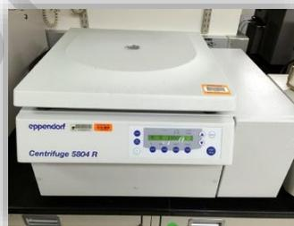
**Ligar e desligar:** Pressionar o botão liga e desliga na lateral da centrifuga conforme quadro a seguir:
