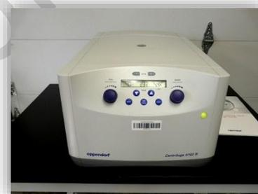
**Ligar e desligar:** Pressionar o botão liga e desliga atrás da centrifuga conforme quadro a seguir:
